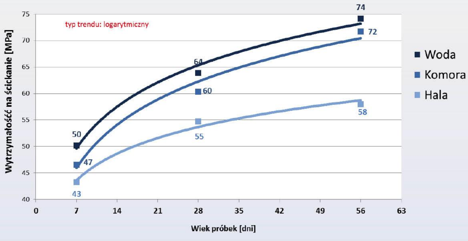
Wytrzymałość betonów przechowywanych w różnych warunkach wilgotnościowych CEM I 42,5 R
